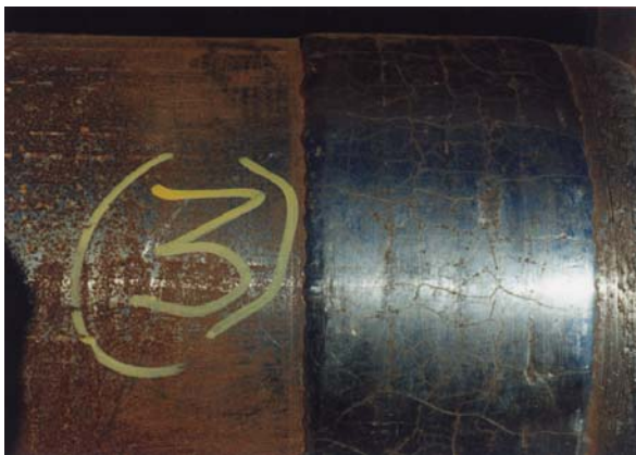
原有已磨损的 200XT 耐磨层
