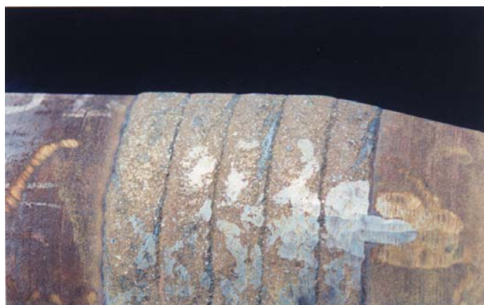
在 18° 斜坡焊道上的新 200XT 耐磨带
