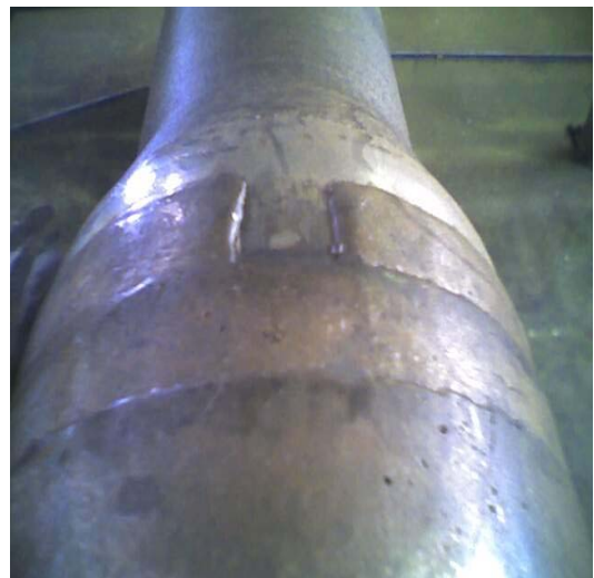
经修焊后达到合格标准的空隙区
