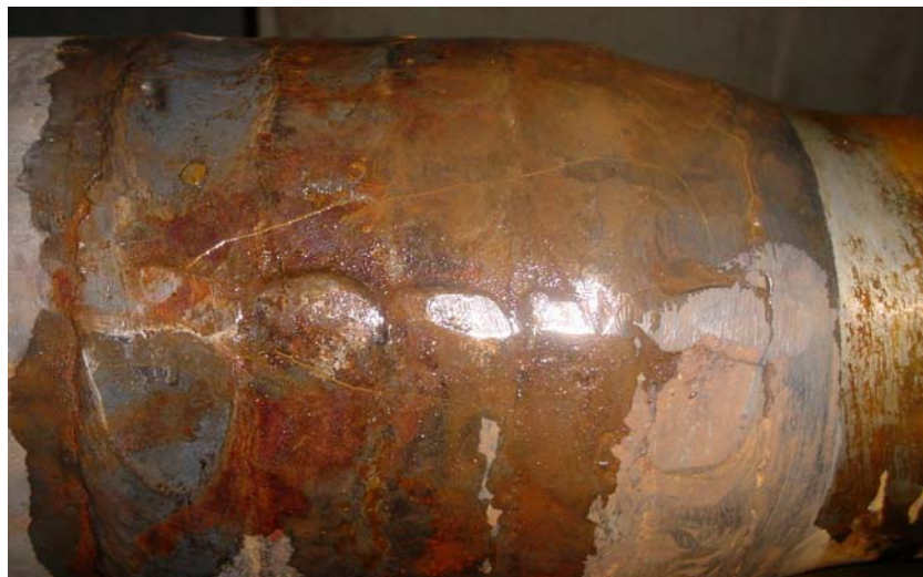
合格的新 300XT 耐磨带裂纹形态 (在下页中,同样是显示在紫外光下的)
