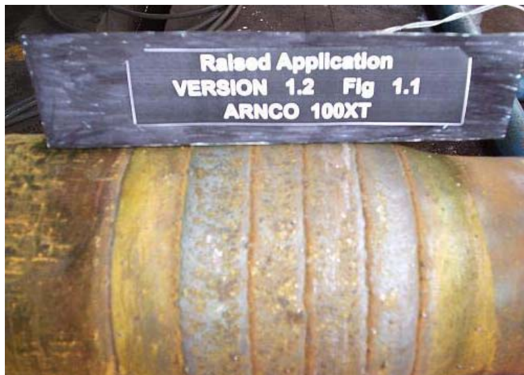
带有 18° 斜坡焊道的合格的 100XT 耐磨带
