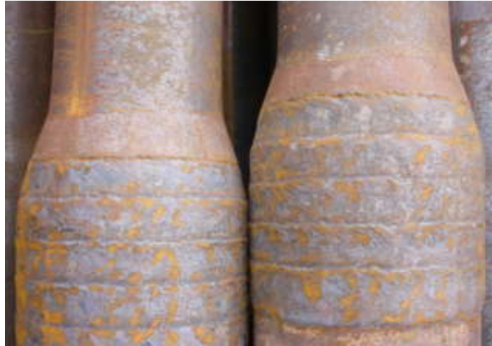
位于 18° 斜坡焊道底部的咬边
