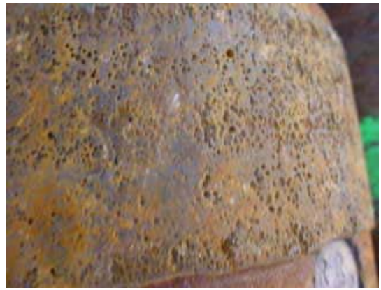
过多气孔，已磨损但仍完整
