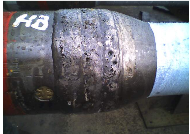
新加焊的耐磨带层内有过多气孔 明显不合格
