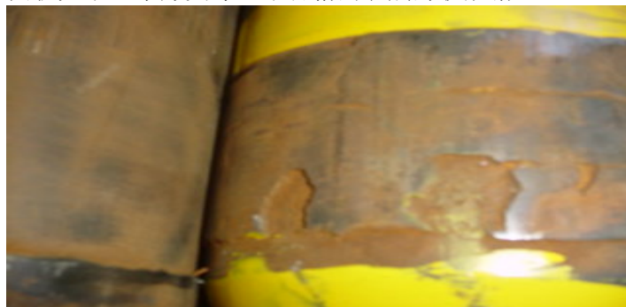
300XT 耐磨带厚处的表层片状脱落
