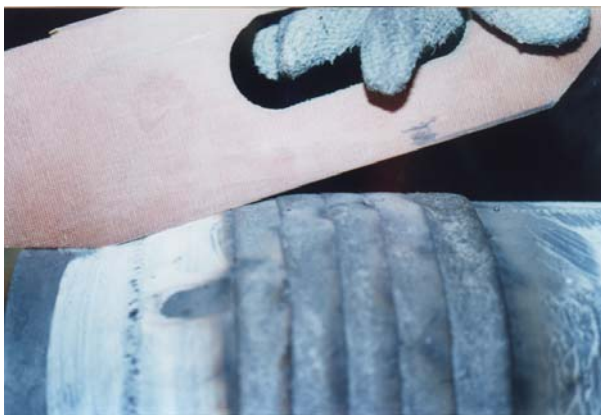
合格的齐平斜坡焊道
