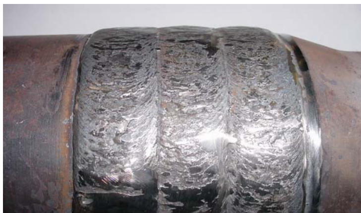
合格的 100XT 耐磨带——“无切槽接头”的焊接
