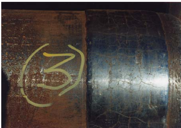
原有已磨损的 200XT 耐磨层
