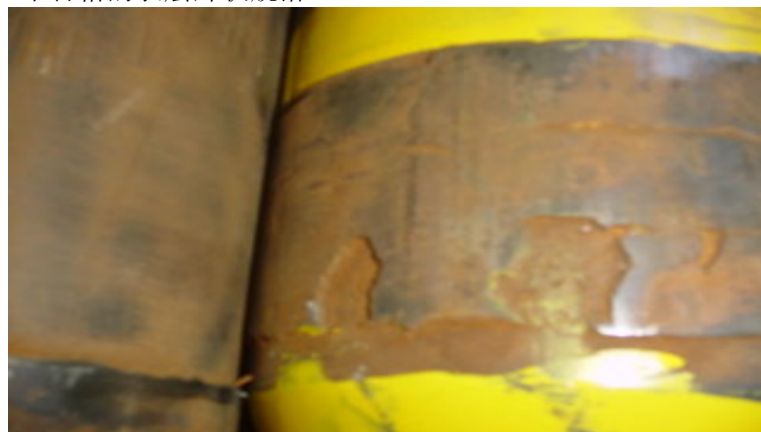
300XT 耐磨带厚处的表层片状脱落
