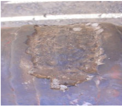
在溶合线位置的剥落
