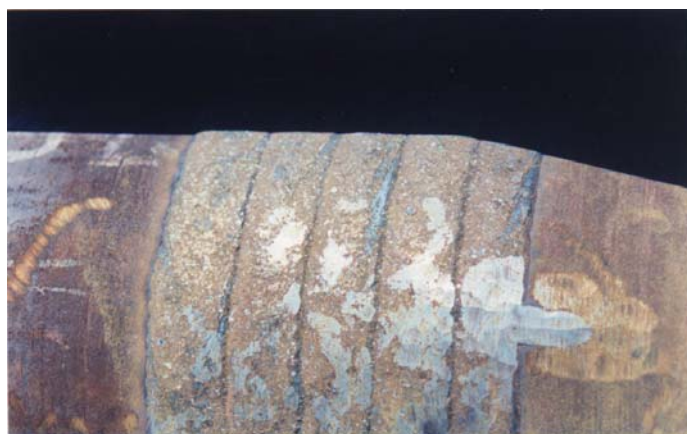
在 18° 斜坡焊道上的的新 200XT 耐磨带
