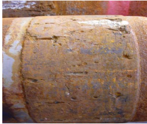
气孔导致的剥落
