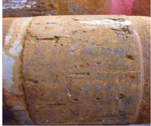
气孔导致的剥落
