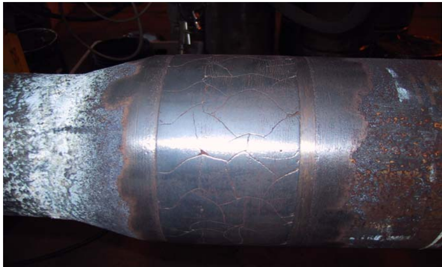
合格的已磨损 300XT 耐磨带裂纹形态
