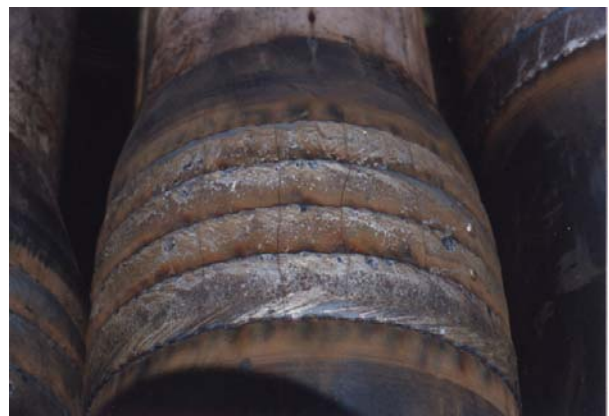
在已磨损的耐磨带上加焊的新 200XT 耐磨带
