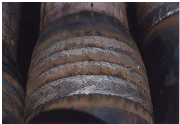
在已磨损的耐磨带上加焊的新 200XT 耐磨带
