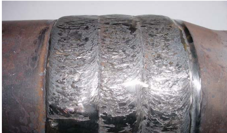
合格 100XT 耐磨带——“无切槽接头”的焊接
