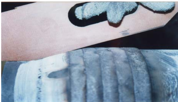
合格的齐平斜坡焊道
