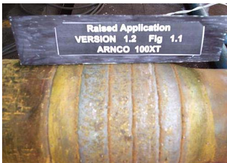
带有 18° 斜坡焊道的合格的 100XT 耐磨带
